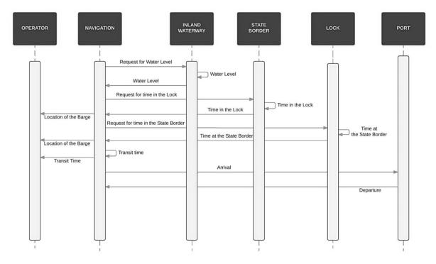
Fig. 4. Agents' communication at Navigation Rys. 4. Komunikacja agent w nawigacji
