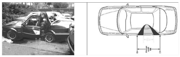
Fig. 7. Real crush and appropriate measurements on impact side [9] Rys. 7. Właściwy pomiar wgniecenia po stronie uderzenia [9]
