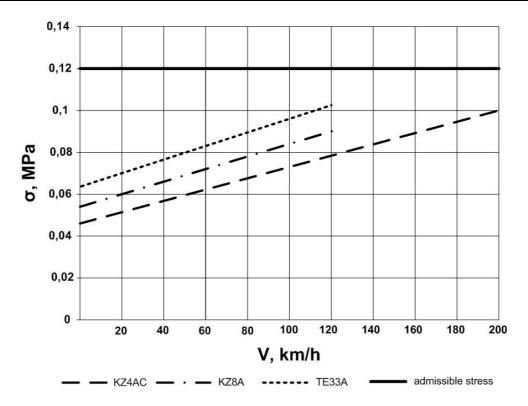
Fig. 5. Stress in the road bed Puc. 5. Напряжение в земляном полотне
