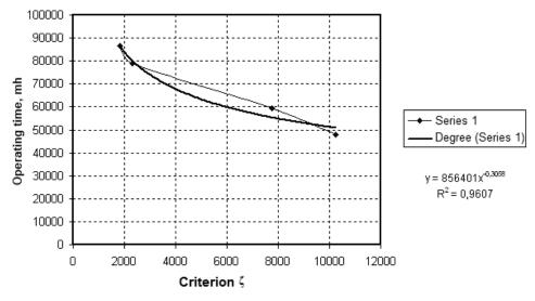
Fig. 3. Results of ζ criterion adaptation to AB "LG" cargo locomotive diesels Рис. 3. Результаты ζ критериальной адаптации для дизелей AB "LG" грузовых локомотивов
