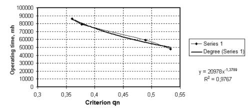
Fig. 4. Results of  $q_n$  criterion adaptation to AB "LG" cargo locomotive diesels Рис. 4. Результаты  $q_n$  критериальной адаптации для дизелей AB "LG" грузовых локомотивов
