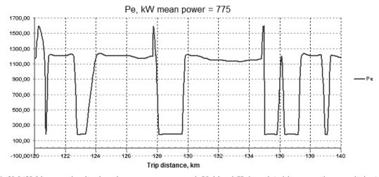
Fig. 5. 2M62M locomotive load cycle parameters on track Vaidotai-Kybartai (without traction restriction) Рис. 5. Параметры цикла нагрузки локомотива 2M62M на участке Vaidotai-Kybartai (без ограничений по тяге)
