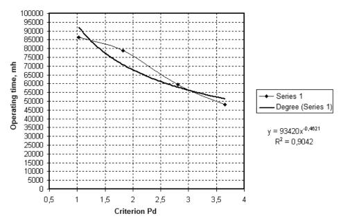
Fig. 2. Results of  $P_d$  criterion adaptation to AB "LG" cargo locomotive diesels Рис. 2. Результаты  $P_d$  критериальной адаптации для дизелей AB "LG" грузовых локомотивов
