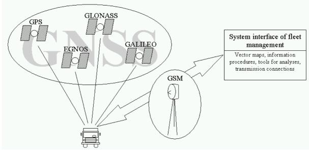
Fig. 1. GNSS technologies in vehicle fleet management systems. Rys. 1. Technologie GNSS w systemach zarządzania flotą pojazdów.
