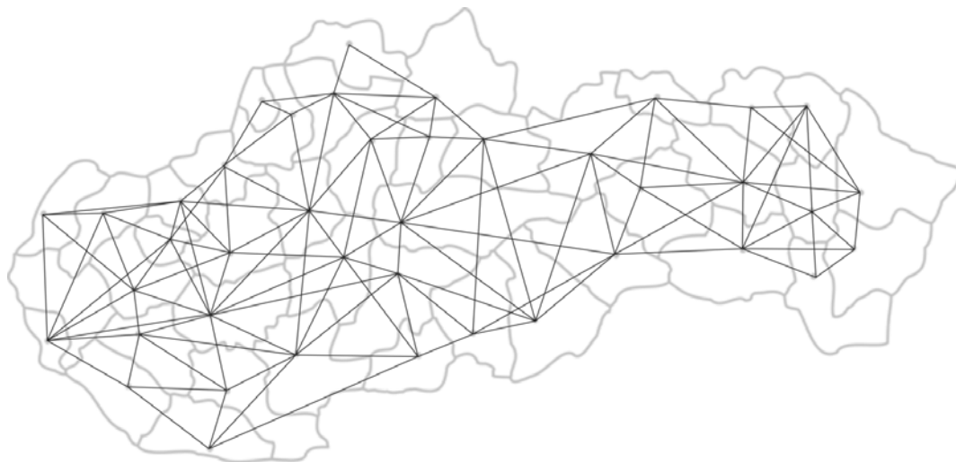
Fig. 1. Underlying graph representing the postal middle-level nodes and their road connections Rys. 1. Wykres prezentujący pocztowe węzły średniego poziomu i ich połączenia drogowe
