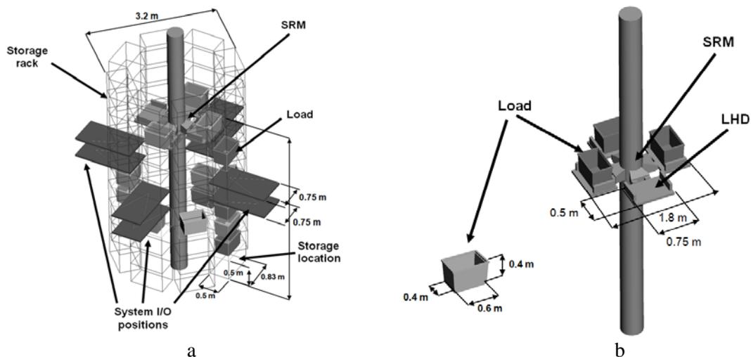
Fig. 2. a) C-AS/RS system view, b) SRM
