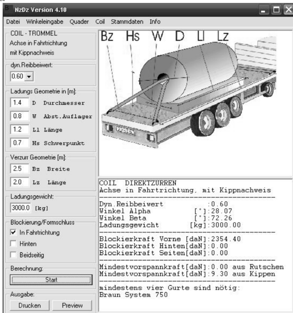
Fig. 4. Lashing equipment adjustment with the use of Braun company application Rys. 4. Dopusowanie lin mocujących przy pomocy aplikacji firmy Braun
