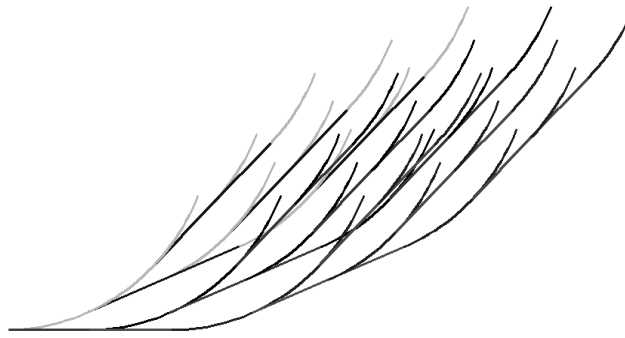
Fig 4. Graphical interpretation of a grammar G_{turn\_left} for radius R=5m Rys. 4. Interpretacja graficzna wywodu słów gramatyki G_{turn\_left} , dla promienia R=5m
