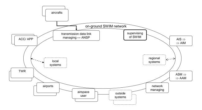
Fig. 3. Functional view on structure of the new generation ATM system concept Rys. 3. Funkcjonalne spojrzenie na architekturę koncepcji systemu ATM nowej generacji
