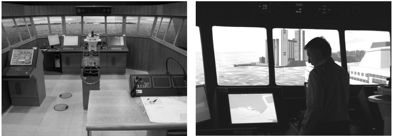
Fig. 6. Bridge A at MTEC (with 270° visual projection) and captain “at work” Rys. 6. Mostek A w CIRM (kąć projekcji równy 270°) i kapitan przy pracy
