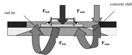
Fig. 1. Demonstration scheme of the influence of railroad and automotive vehicles on a traditional crossing Rys. 1. Rysunek poglądowy oddziaływania pojazdów szynowych i samochodowych na tradycyjny przejazd
