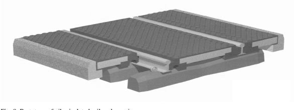
Fig. 8. Prototype of vibroisolated railroad crossing Rys. 8. Prototyp wibroizolowanego przejazdu kolejowego
