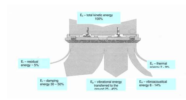
Fig. 9. Energetic balance of vibroisolated railway crossing Rys. 9. Bilans energetyczny wibroizolowanego przejazdu kolejowego
