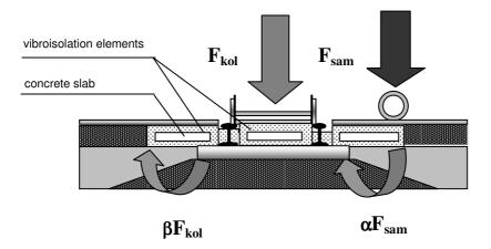
Fig. 2. Demonstration of vibroisolated railway crossing Rys. 2. Rysunek poglądowy wibroizolowanego przejazdu kolejowo-samochodowego
