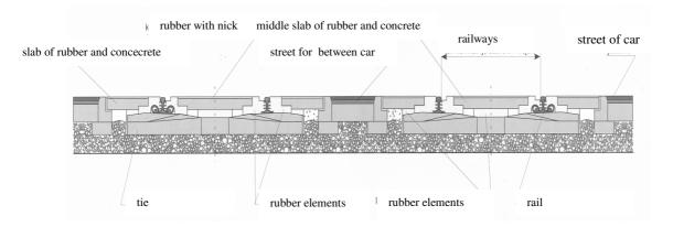
Fig. 4. Technical conception of vibroisolated railway crossing Rys. 4. Koncepcja techniczna wibroizolowanego przejazdu kolejowego
