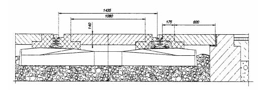
Fig. 6. Prefabricated concrete slab without elastomer anti-slide layer Rys. 6. Prefabrykowana płyta betonowa bez warstwy przeciwpoślizgowej
