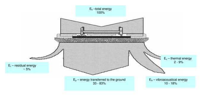
Fig. 10. Energetic balance of traditional railway crossing Rys. 10. Bilans energetyczny tradycyjnego przejazdu kolejowego
