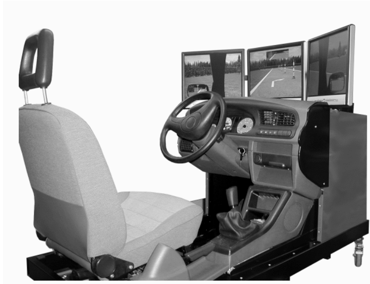
Fig. 4. Driver's behaviour and response to ADAS and IVIS can be simulated Rys. 4. Można symulować zachowania i odpowiedzi kierowcy na ADAS oraz IVIS
